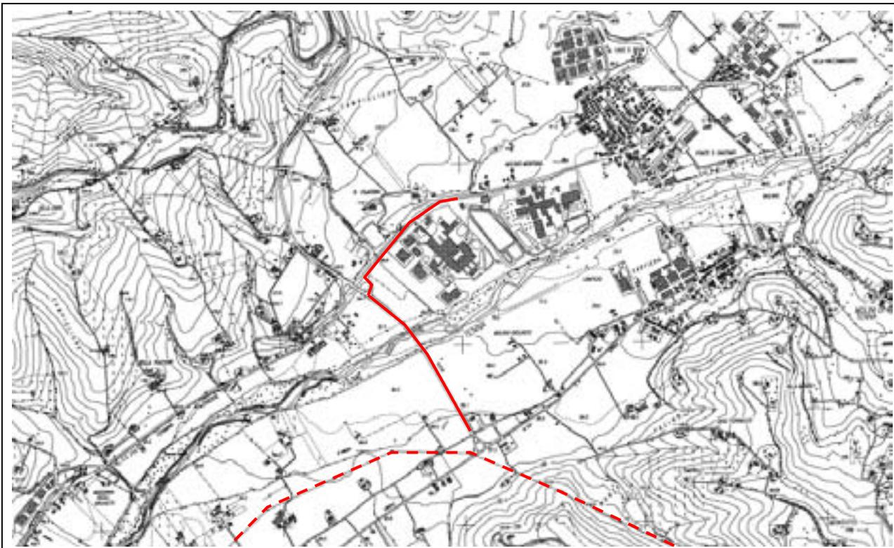
Figura 4.57: Tracciato dell'elettrodotto aereo di AT esistente (linea tratteggiata) e interrato di progetto (linea continua)
